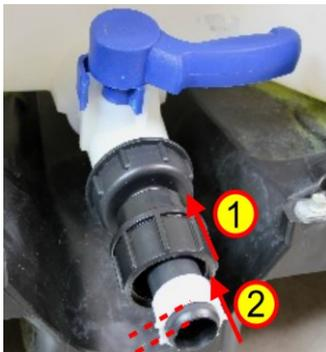
**3** Führen Sie die Überwurfmutter des Anschlussklemmfittings über den Stutzen. Dann ebenso den weißen Grip-Ring, so dass der Stutzen ca. 10mm zum Vorschein kommt.
