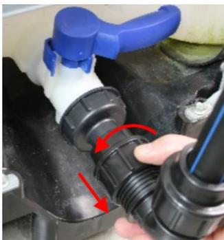
**5** Bringen Sie den Schwanenhals in die gewünschte Position und schrauben Sie die Überwurfmutter des Klemmfittings fest.
