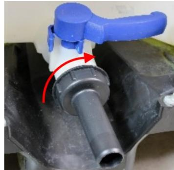
**2** Schrauben Sie den S60\*6 Anschluss mit Stutzen fest auf den Klappenhahn am IBC Container.
